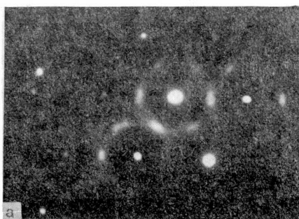
Rys.61. a - obraz dyfrakcyjny pierwszej strefy Lauego pasa [00.1] węglków heksagonalnych ze stopu 5, b - schemat dyfraktogramu wskazujący na złożenie dwóch obrazów dyfrakcyjnych
