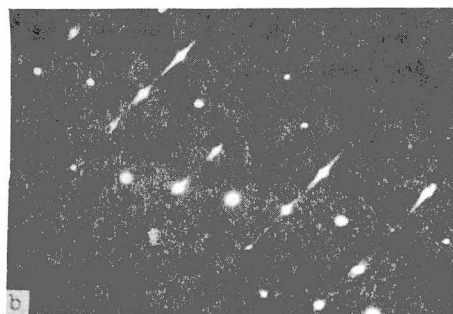
Rys. 51. a - błędy ułożenia w obszarach mikrobliźniaków w węgliku ze stopu 4, b - dyfraktogram elektronowy z badanego obszaru, c - rozwiązanie dyfraktogramu wskazujące na występowanie dwóch sieci ortorombowych wykazujących orientację bliźniaczczą
