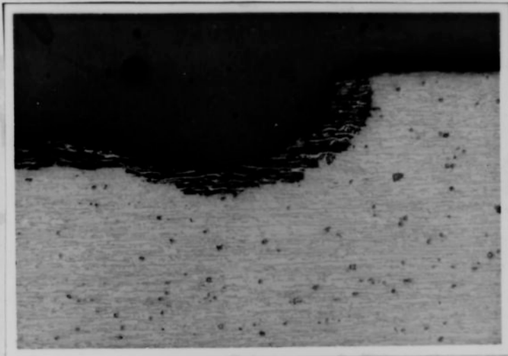
Rys.II.24. Zniszczenie korozyjne stali H18N10MT przebiegające w osnowie austenitycznej /białe pasma w obrębie zniszczenia to ferryt \delta / po 432 ks/120h/ ekspozycji w roztworze podchlorynu sodowego o stężeniu 10 \text{ kg/m}^3 chloru aktywnego w temperaturze 293\text{K}/20^\circ\text{C} / Powiększenie 100 razy, próbka trawiona w mieszaninie \text{HF}, \text{HNO}_3 , gliceryna /stosunek objętościowy 2:1:3)
