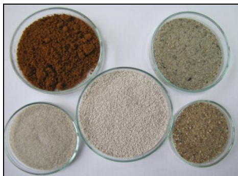
Rys. 5. Piaski użyte do sporządzenia zapraw klejowych cementowych Fig. 5. Sands used for preparation of adhesive and cement mortars
