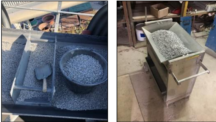
Rys. 4. Przygotowanie próbki do badań: pobranie prób z przenośnika taśmowego (z lewej), uniwersalny dzielnik prób DP do kwartowania (z prawej)
