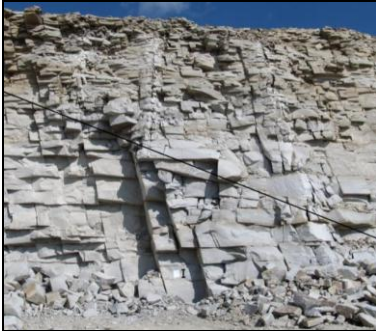
Rys. 21. Widok na ścianę wyrobiska i wynik urabiania MW w granicie (Malewski&Rink, 2012)
