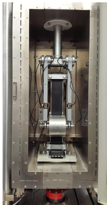
Rys. 3. Widok stanowiska do badań oporów toczenia taśmy po krążnikach – badania w małej skali (Woźniak i in., 2018)
