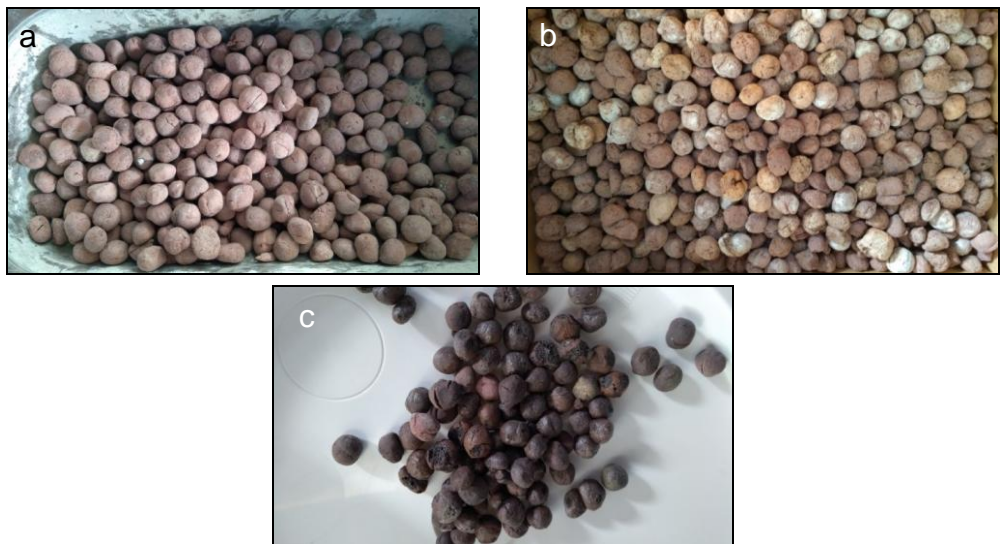
Rys. 2. Próbkki lekkich kruszywo sztucznych z odpadu granitowego;
