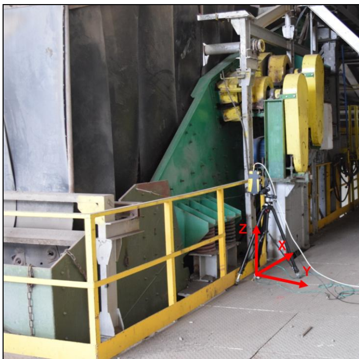
Rys. 2. Lokalizacja punktów pomiarowych i kierunki pomiarowe na stanowisku 2 (SWR-3) przy wibroizolatorze Fig. 2. Location of measuring points and measurement directions at Station 2 (SWR-3) near a vibration isolator
