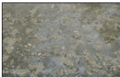
Rys. 1. Próbkę po badaniu wg AAR-3 z widocznymi odbarwieniami, dolomit Fig. 1. Specimen with spots tested according AAR-2, dolomite
