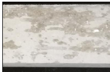
Rys. 8. Próbkę po badaniu wg AAR-4 z widocznymi odbarwieniami i białawymi nalotami, granit
