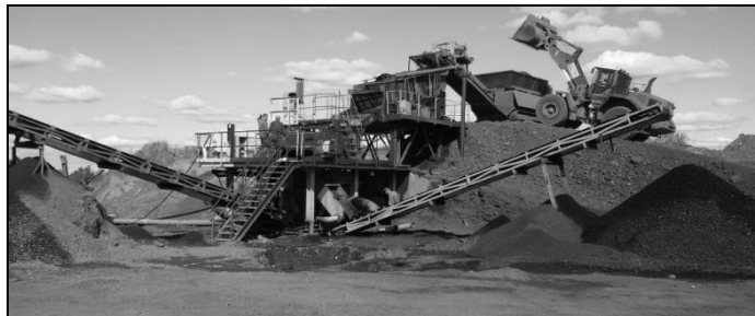
Rys. 2. Węzeł wzbogacania z klasyfikatorem pulsacyjnym K-102 (źródło własne) Fig. 2. Beneficiation node with K-102 pulsating classifier (own source)
