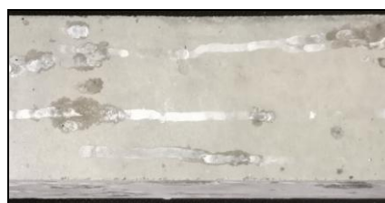
Rys. 4. Próbkę po badaniu wg AAR-3, nacieki krzemionki w postaci żelu, żwir naturalny Fig. 4. Specimen with silica gel smears tested according to AAR-3, Natural gravel
