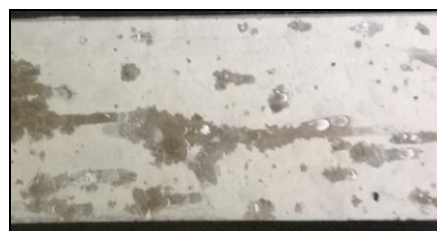
Rys. 10. Próbkę po badaniu wg AAR-4 z widocznymi odbarwieniami, wapień Spratt
