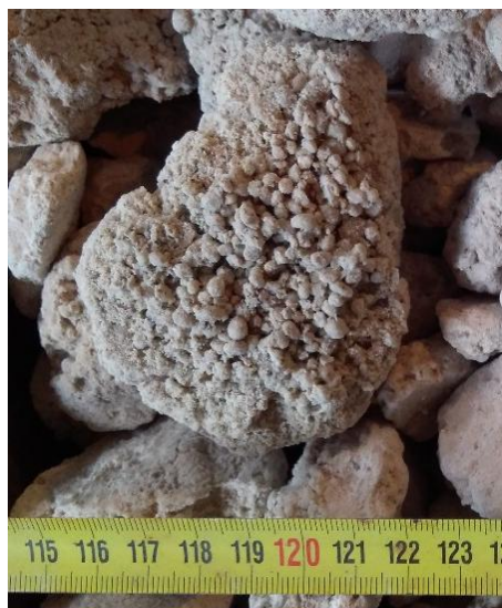
Rys. 1. Widok agregatu Gransilu składający się z granul o średnicy 2–4 mm
