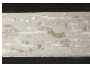
Rys. 3. Próbkę po badaniu wg AAR-3 z białymi naciekami żelu krzemionkowego, granit Fig. 3. Specimen with white silica gel smears tested according AAR-3, granite
