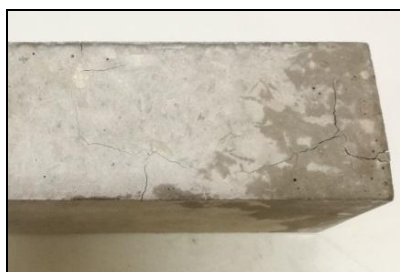
Rys. 5. Próbkę po badaniu wg AAR-3 z widocznymi spękaniami na powierzchni, dolomit Pittsburg Fig. 5. Specimen with cracks seemed on the surface, tested according to AAR-3, dolomite Pittsburg
