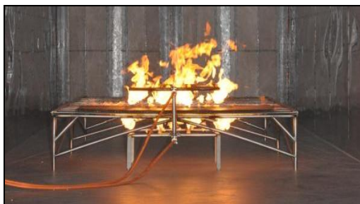
Rys. 6. Stanowisko badań palności taśm metodą B wg PN-EN 12881-1:2014-09 Fig. 6. Flame testing of belts by method B according to PN-EN 12881-1:2014-09
