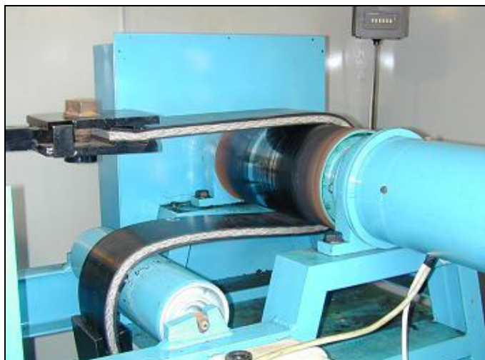
Rys. 8. Stanowisko do badania palności taśm metodą bębna ciernego Fig. 8. The friction drum for testing the flammability of belts
