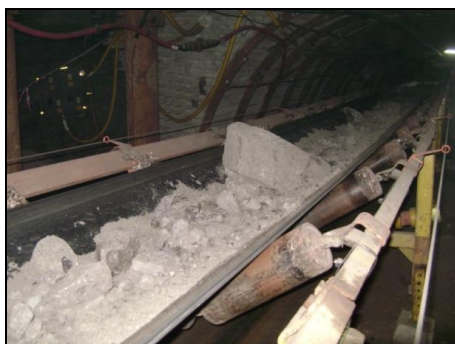
Rys. 8. Widok standardowego przenośnika oraz zamontowane stanowisko pomiarowe wraz z czujnikami do rejestracji sił poziomych i pionowych
