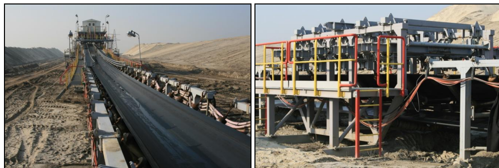
Rys. 1. Badany przenośnik nadkładowy Z12 (B2250) oraz człon pomiarowy trasy przenośnika Fig.1. Tested overburden conveyor Z12 (B2250) and the test stand on the conveyor route
