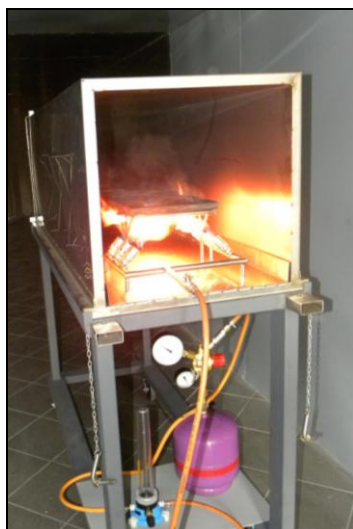
Rys. 7. Stanowisko do badania palności taśm metodą C wg PN-EN 12881-1:2014-09 Fig. 7. Flame testing of belts by method C according to PN-EN 12881-1:2014-09
