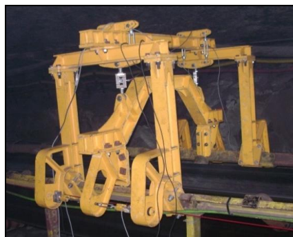
Rys. 8. Widok standardowego przenośnika oraz zamontowane stanowisko pomiarowe wraz z czujnikami do rejestracji sił poziomych i pionowych
