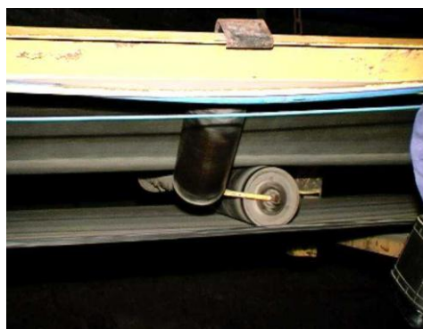
Rys. 7. Idea przekazywania napędu z cięgna dolnego do górnego poprzez krążniki, wykorzystana w przenośniku modułowym „LEGMET 2000”;
