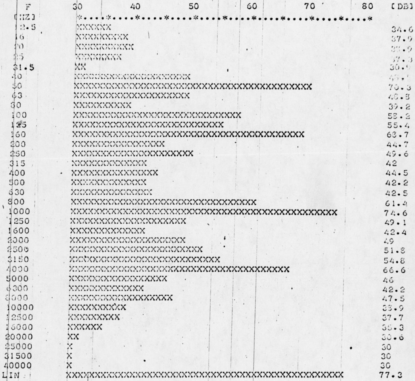
RYŚ. 12. ROZKLAD WIDMOWYSKŁADOWEJ PRĄDU KOLEKTORA ELEKTRONÓW, PODCZAS SPAWANIA WIAZKA ELEKTRONOWA.
