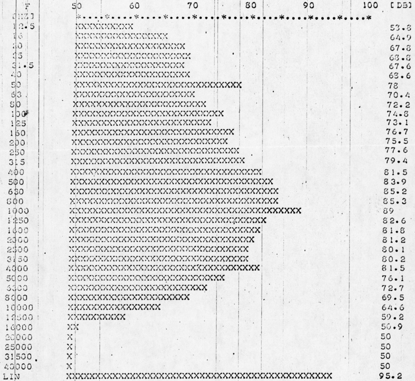
RYS. 8. ROZKLAD WIDMOWSKLADOWEJ PRADU KOLEKTORA ELEKTRONOW, PODCZAS SPAWANIA WIAZKA ELEKTRONOWA.
