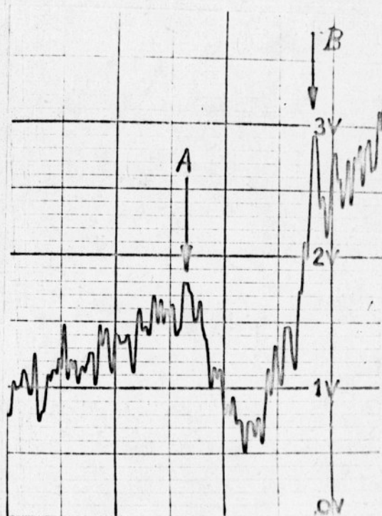
Rys. 17. Przekrój wzdłużny przez przetop w stali 1H18N9T /a/ oraz charakterystyka U_{wy} = f(t) /b/. Warunki spawania: U = 30V , I = 67 mA , V_s = 40 cm/min , \frac{dI}{dt} = 1 A/min .
