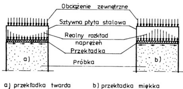
Rys. 4.1. Wpływ sztywności przekładek na naprężenia powstające na obciążonej powierzchni próbki [249].
