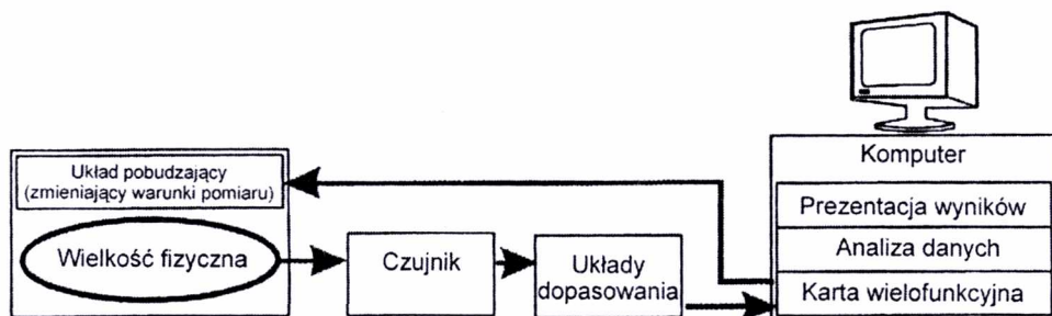
Rys. 3.8. Przykład systemu akwizycji danych opartego na wielofunkcyjnej karcie montowanej bezpośrednio w komputerze
