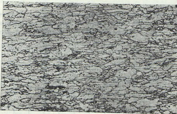
kw. azot. Ryc. 16. pow. = 100 Struktura stali po gorącym walcowaniu przy grub. 2,8 mm (materiał huty II).
