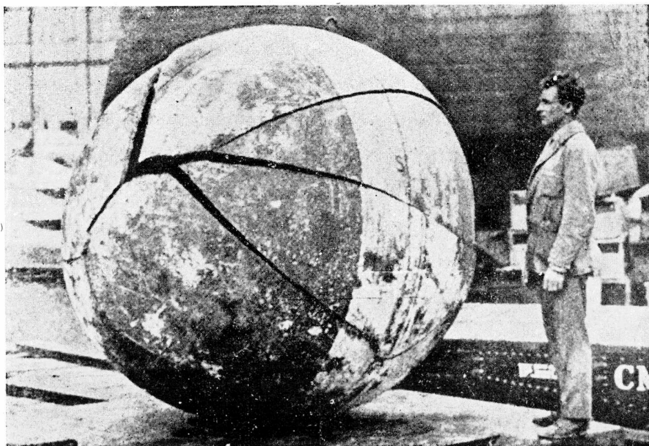
Rys. 21. Układ nieprzecinających się pęknięć zbiornika stalowego.
