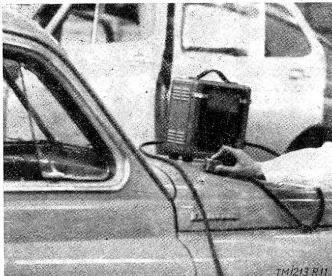
Rys. 11. Pomiar grubości pokrycia lakierniczego nadwozia samochodu M-20 Warszawa.
