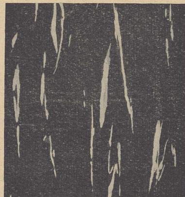
Rys. 5. Ziarna proszku Al płatkowego w przekroju
