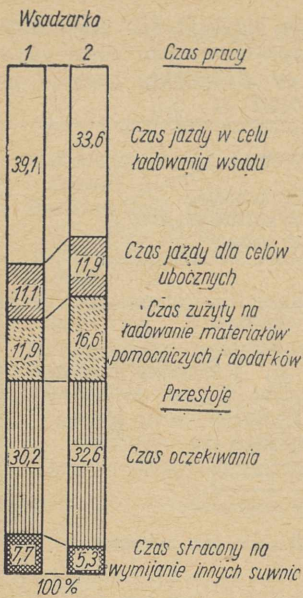
Rys. 2. Przebieg pracy wsadzarek
