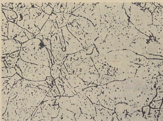
Rys. 8. Wydzielenie azotków wzdłuż linii poślizgu. 6-godzinne nagrzewanie do 100 °C. Część nieodkształcona próbki \times 200 wg Köstera
