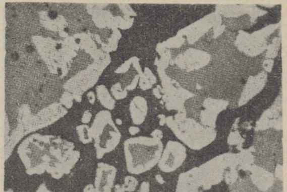
Rys. 5. Spiek o stopniu utlenienia 94,8 %. Przykład utlenienia wzdłuż granic ziarn. Powiększone 630 ×
