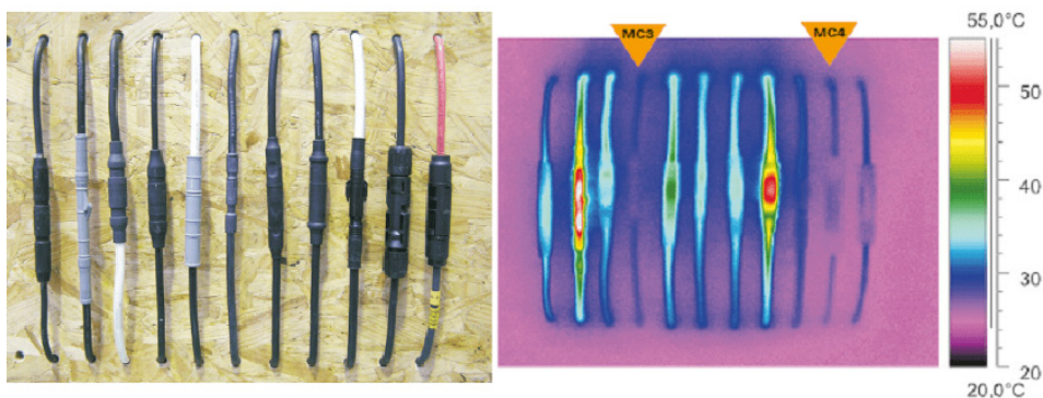
Fot. 3. Badania termowizyjne złącz MC3 i MC4 [5]
