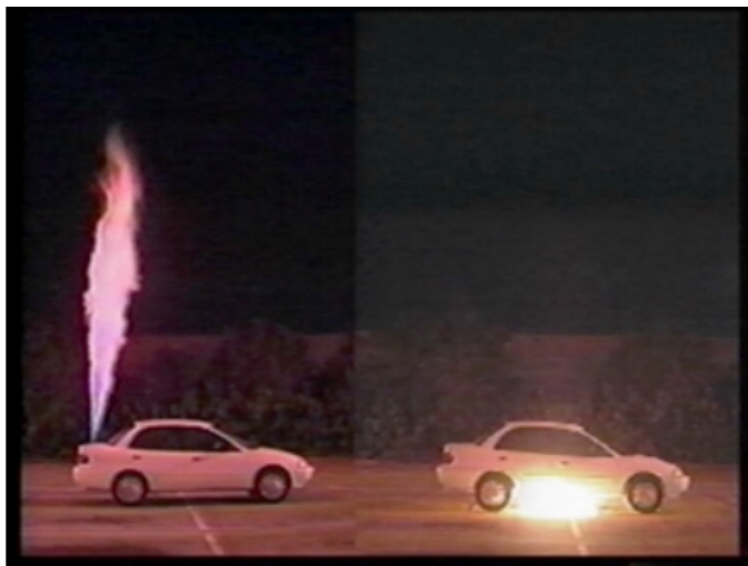
Rys. 5. Celowe rozszczelnienie zbiornika ze sprężonym wodorem po lewej i z benzyną po prawej [14]
