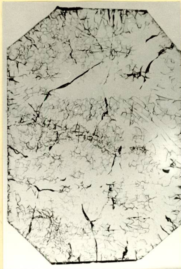
Rys.71. Pęknięcia wywołane studzeniem przy maksymalnym spadku temperatury powierzchni
