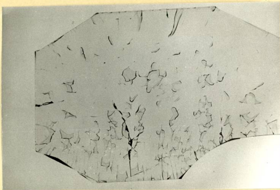
Rys. 72. Pęknięcia wywołane studzeniem przy maksymalnym spadku temperatury powierzchni \Delta t_{\text{skr}} = 110 \text{ }^{\circ}\text{C}
