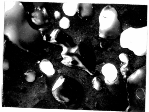
Rys. 23. Zdjęcia mikroskopowe charakterystycznych obszarów obserwacji półkoków otrzymanych z węgla gazowokoksowego typ. 34, z kop. Knurów /powiększenie 250x, a-światło zwykłe, b-światło spolaryzowane/
