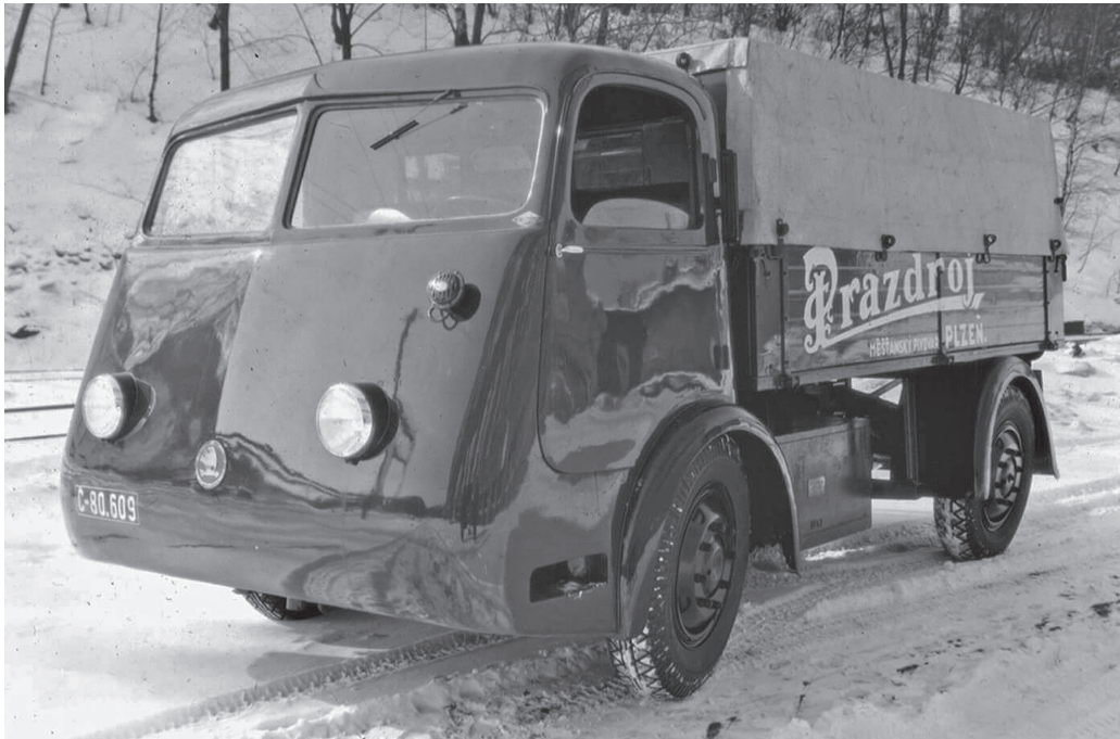
Rysunek 6. Samochód Škoda Electric Beer Truck o ładowności 3 ton
