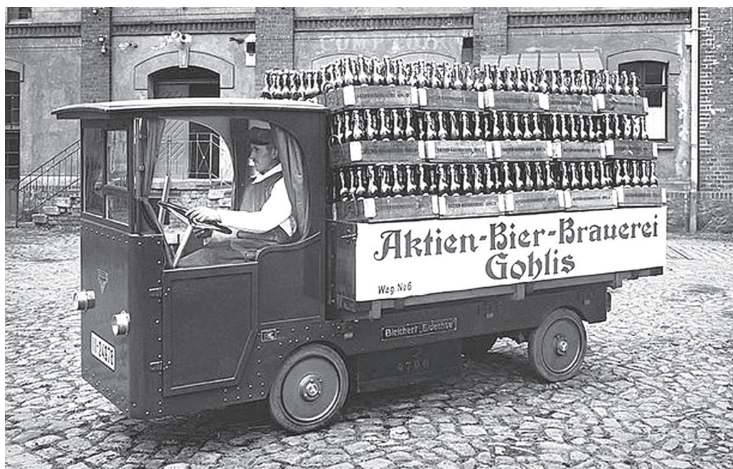
Rysunek 5. Samochód dostawczy Bleichert o ładowności 1500 kg
