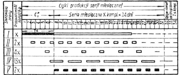
Rys. 5. Harmonizacja przebiegu produkcji wg systemu „z przestojami” na linii pojedynczej o różnej przepustowości stanowisk
