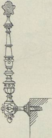
Geländerstab mit Krücke. \frac{1}{20} n. Gr.
