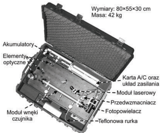
Rys. 27. Fotografia wnętrza sensora NO 2 Fig. 27. Photography of NO 2 sensor
