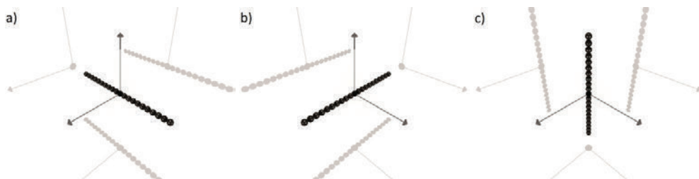
Rys. 22. Regularne łańcuchy cząstek sadzy n_p = 21 , r_p = 50 nm wyrównane odpowiednio do osi Z , X i Y Fig. 22. Regular chains of soot particles n_p = 21 , r_p = 50 nm aligned to Z , X and Y axis respectively
