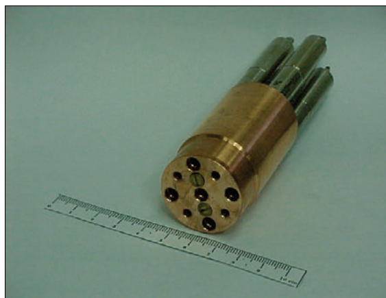
Rys. 20. Wielokomponentowa komórka termometryczna nowej generacji – model IMG C Fig. 20. A new generation multicompartiment cell made at IMG C
