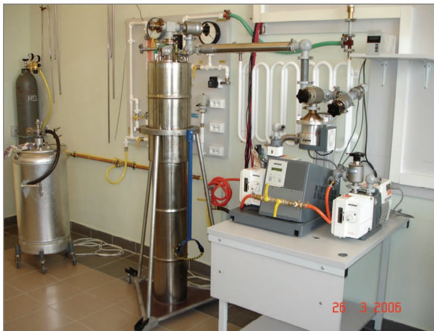
Rys. 10. Kriostat adiabaticzny z aparaturą próżniową Fig. 10. An adiabatic cryostat with a vacuum system
