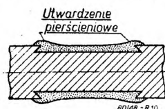
Rys. 10. Utwardzone pierścienie na powłoce wałka metalizowanego.
