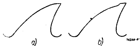
Rys. 2. Krzywoliniowe zarysy zębów freza.
