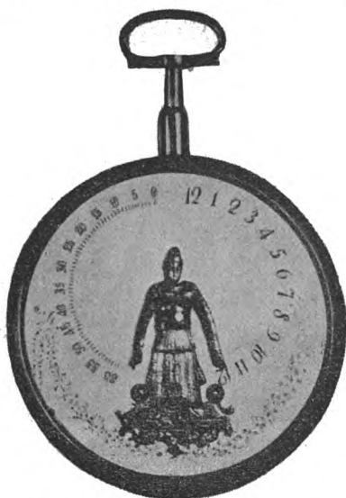
Rys. 5. Zegarek kieszonkowy z 1800 r., w którym za naciśnięciem główki, ręce zakonnika podnoszą się i jedna wskazuje godziny a druga minuty.
