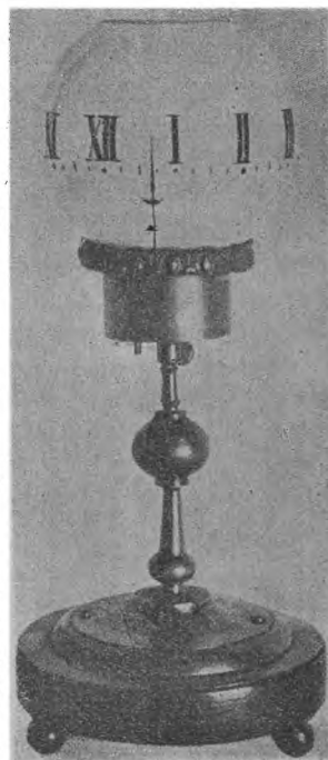
Rys. 7. Oryginalny zegar nocny z 1850 r., w którym nieruchoma wskazówka wskazuje godziny na obracającej się mlecznej kuli, oświetlonej od wewnątrz lampką oliwną.
