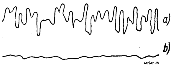
Rys. 1. a) Powierzchnia tłoka silnika samochodowego po dokładnym toczeniu diamentem; b) ta sama powierzchnia po oscylacyjnym szlifowaniu wykańczającym. Powiększenie: w kierunku wzdłużnym — 150 krotnie, w kierunku poprzecznym 40000 krotnie.
