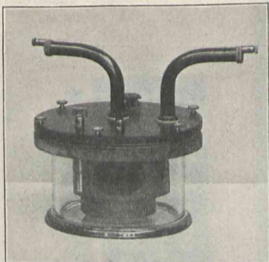
Der Transformator im Sender.
