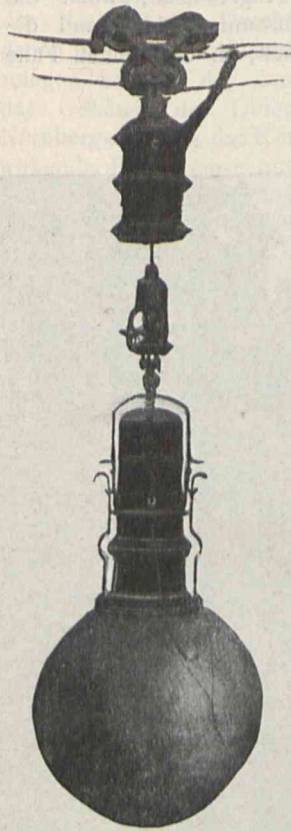
Am Aufzugsseil hängende Lampe.
