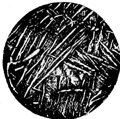
Rys. 8. Mikrostruktura tytanu hartowanego w oleju przy 1100° C *
