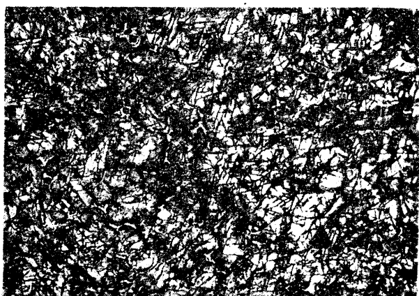
Rys. 2. Mikrobudowa dolnej warstwy wielowarstwowej spoiny wykonanej elektrodą ES 18 W. Pow. \times 250 . Traw. kw. azotowym
