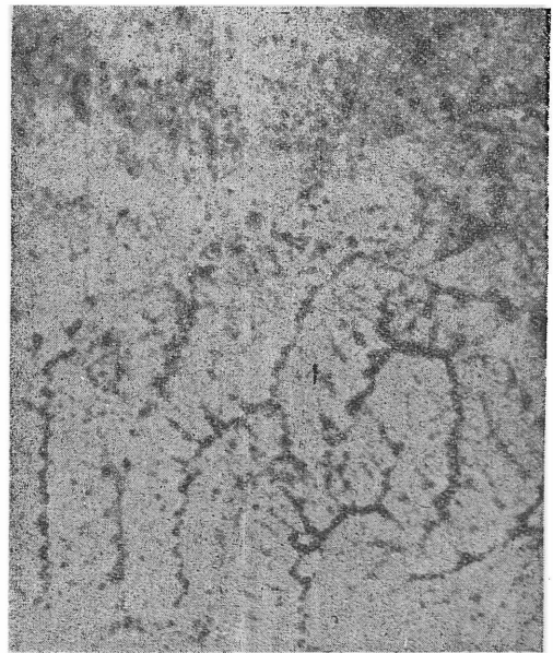
Rys. 5. Koloidalny obraz na stali miękkiej, zawierającej krzem pow. \times 638 .
