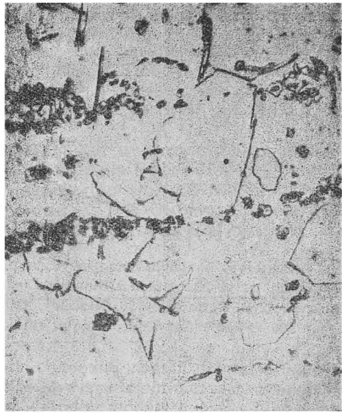
Rys. 3. Ta sama próbka stali 18/8/3/1, trawiona normalnie, pow. \times 638 .
