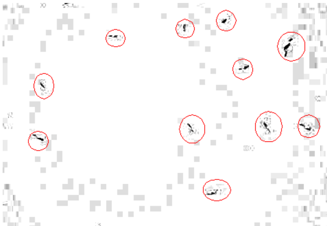
Rysunek 3.19: Obraz różnicowy, widoczne są artefakty (szare obszary) dookoła „wolno” poruszających się obiektów (czarne obszary w czerwonych kołach) oraz artefakty tła (szare prostokąty). Film wejściowy dzięki uprzejmości dr inż. A. Podwin.
