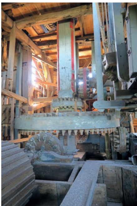
24. Napęd urządzeń z wału królewskiego. Fot. A. Fortuna-Marek
