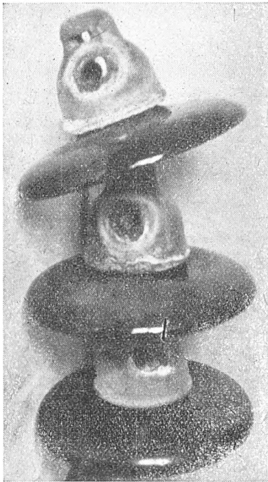
Rys. 11. Izolatory K-3 przebite na linii 35-kilowoltowej z wytopieniem kołpaka w miejscu przebicia (przyczyna wyjaśniona w tekście)
