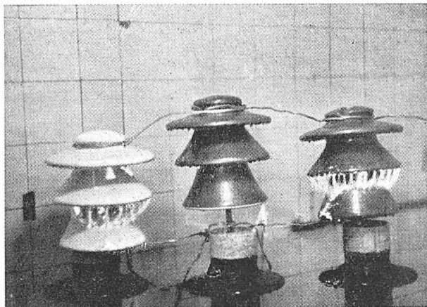
Rys. 3. Wyładowanie przy sztucznym deszczu na izolatorach (lewy izolator niepolewany)
