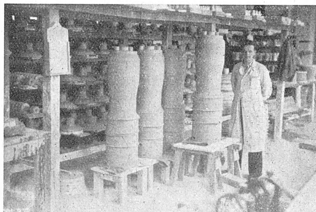
Rys. 2. Izolatory do wyłączników małoolejowych
