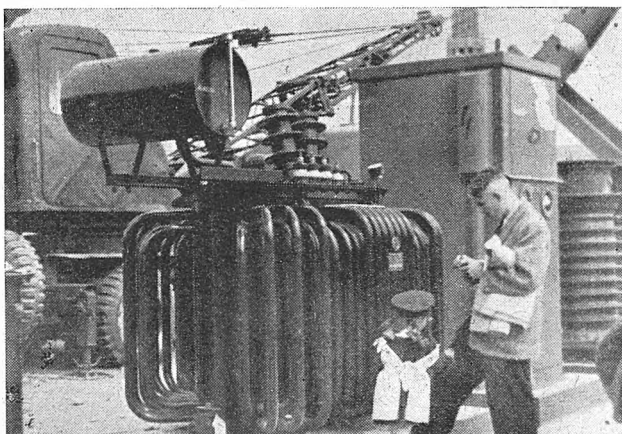
Rys. 11. Transformator energetyczny z chłodzeniem olejowym (ZSRR)
