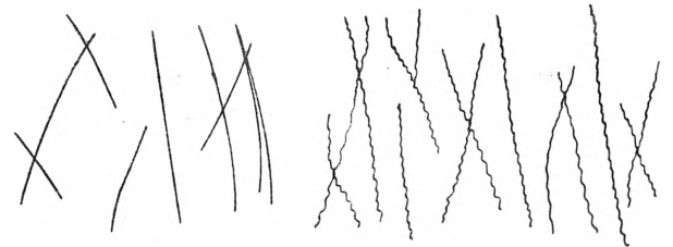
Rys. 4 Ruch cząstek pyłu w polu elektrycznym stałym | Ruch cząstek pyłu w polu elektrycznym pulsującym
