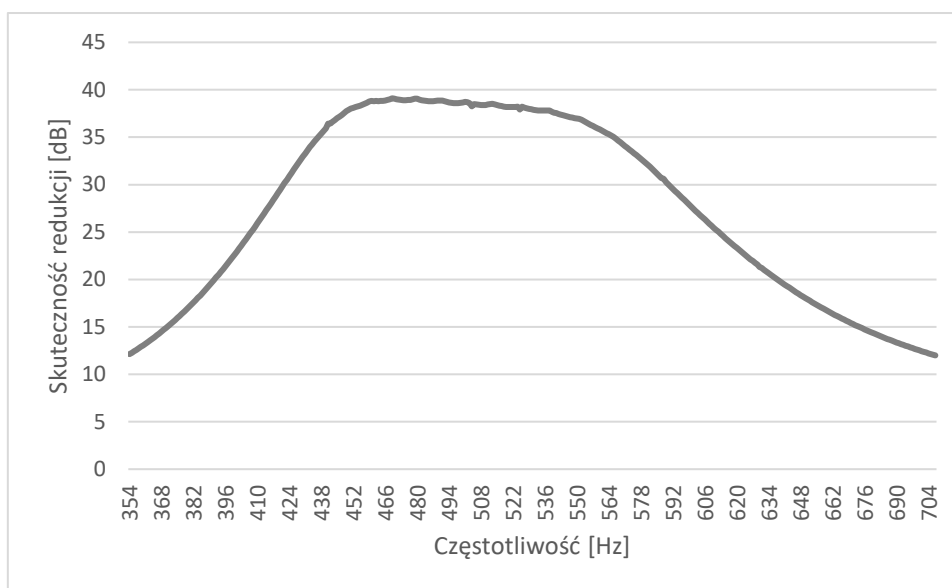
Rys. 106 Skuteczność redukcji poziomu tonu prostego w funkcji częstotliwości dla algorytmu bazującego na detekcji przejść przez zero sygnału filtrowanego filtrem oktawowym 500 Hz
