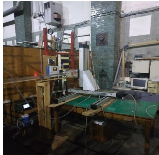
Rys, 7.2 a) Laser helowo-neonowy emitujący wiązkę promieniowania. Rys 7.2 b) Układ nadążny (trawers) zapewniający zmianę pozycji lasera.
