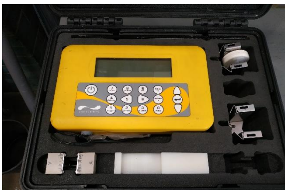
Rys. 5.4. Przepływomierz Microsonic PortaFlow 330, służący do pomiaru prędkości na prostym odcinku rurociągu przed zasuwą nożową.
