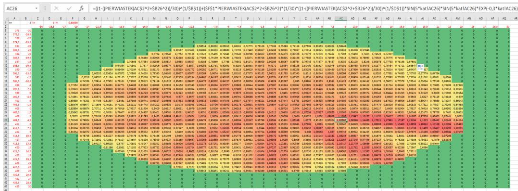
Rys. 4.9. Siatka punktów, wygenerowana w programie MS Excel, do przestrzennej prezentacji modeli rozkładów prędkości.
