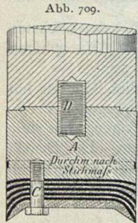
Dichtung der Presskolben für Huber-Pressen.
