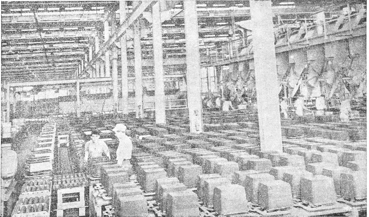
Rys. 16. Transport skrzynek formierskich przy pomocy wózków wałkowych w odlewni Nr 6.
