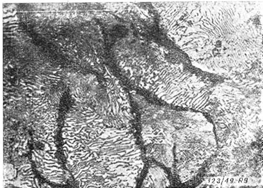
Trawiono 4% HNO 3 w alkoholu pow. × 600.
