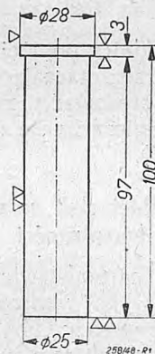
Rys. 1. Kształt próbki Jominy'ego.
