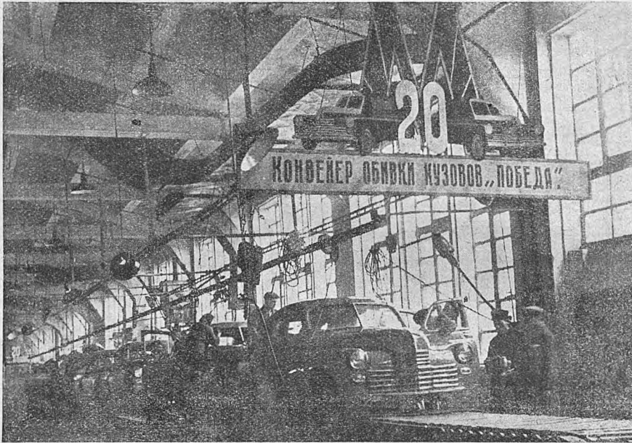
Rys. 5. Pas montażowy nadwozia samochodu M—20 „Pobieda”.
