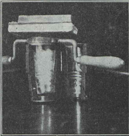
Durch Auflegen einer nassen Asbestplatte wird das Object fertig geblasen.
