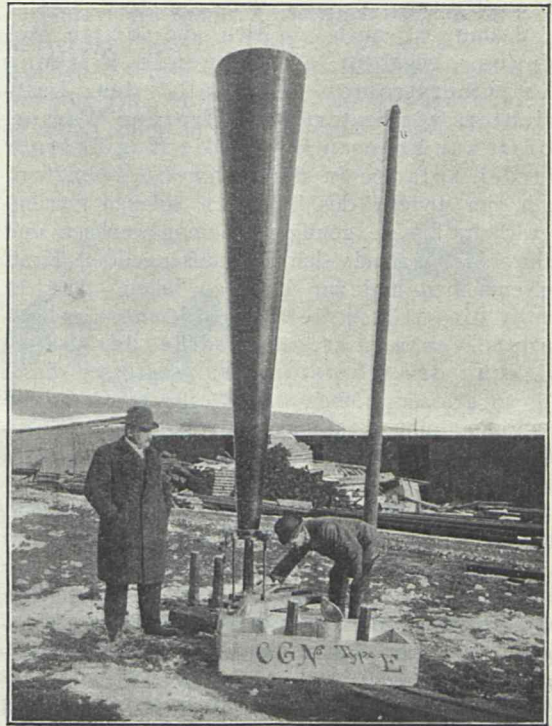
Wetterschiessapparat mit Schalltrichter.
