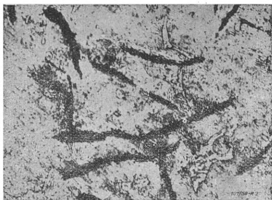
Rys. 2. Żeliwo szare wyjściowe z grafitem pasemkowym. Powiększenie 250 \times . Trawienie roztworem 4% kwasu pikrynowego w wodzie.
