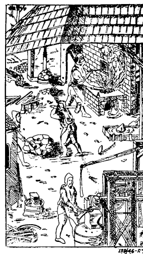
Rys. 2. Dymarka z XVI stulecia wg. G. Agricoli.
