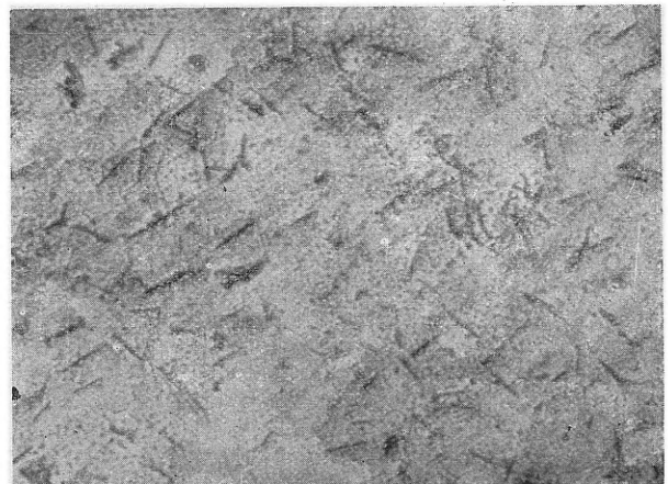
Rys. 10. Igle azotków wydzielone na skutek starzenia się stali przy 250^{\circ}\text{C} i 1^{\text{h}} ( 400\times ).
