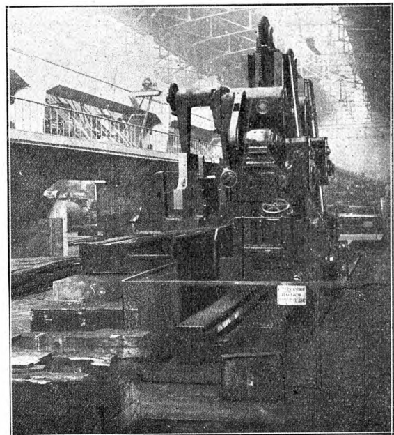
Rys. 2. Frezarka do ram parowozowych (widok z boku).
